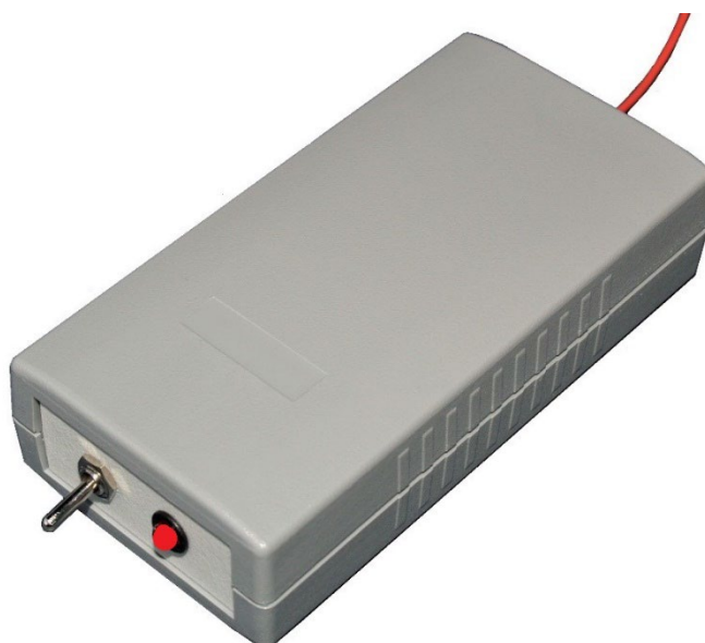
Slika 12. Mogući izgled kratkovalnog odašiljača za amatersku radiogoniometriju postavljen u plastičnu kutiju
