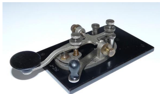
Slika 1. Samuel Morse tipkala za slanje Morseovog kôda Električna shema:
