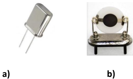
Slika 6. Kristal kvarca u metalnom kućištu a) izvana b) unutra
