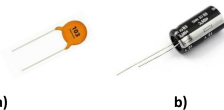
Slika 5. Kondenzator a) keramički b) elektrolitski
