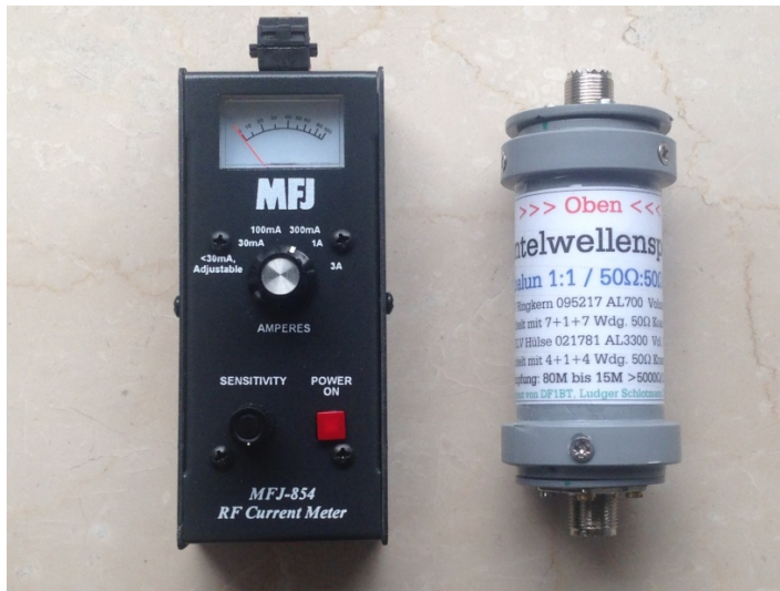
Zangenamperemeter und Mantelwellensperre (Strom-Balun)
