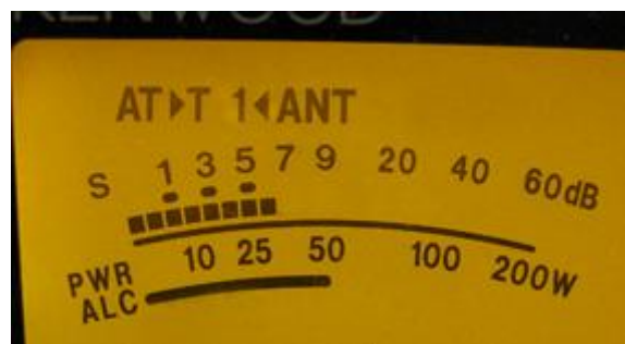
Ispravno podešen predajnik – ista snaga kao i lijevo, ali ALC ne reagira
