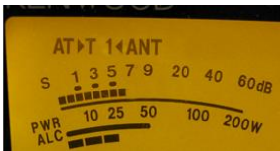
Pogrešno podešen predajnik – postoji ALC pokazivanje
