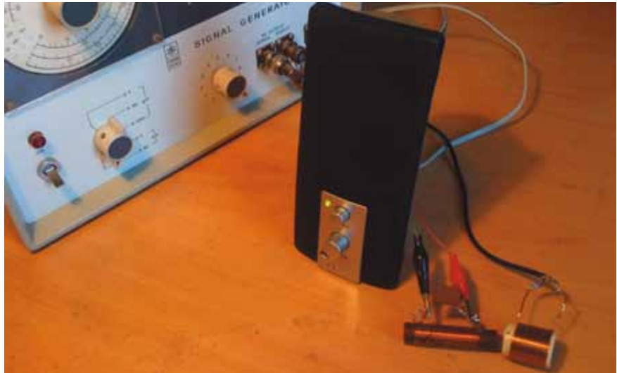
Fotografija cijeloga sklopa. Sasvim desno dolje je zavojnica L SG spojena na signal-generator, lijevo od nje je titrajni krug kojemu mjerimo frekvenciju. Spojen je štikaljkama na mjerilo u kutiji sa zvučnikom i pojačalom.
