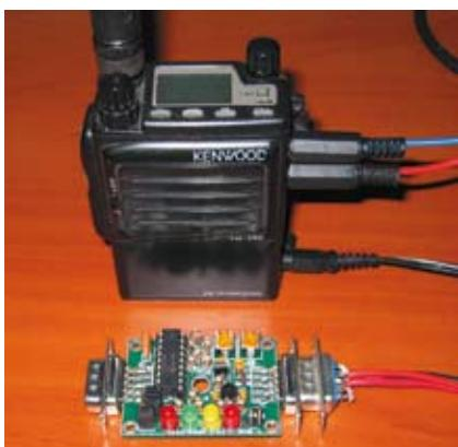
Slika 5. Prijenosna APRS konfiguracija s TinyTrack3 adapterom
