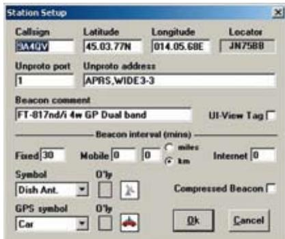
Slika 3. Station set-up izbornik s osnovnim podešenjima UI-view programa
