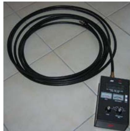
Slika 1. Mjerjenje faktora skraćenja koaksijalnog kabela
