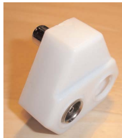
Slika 3. – Izgled gotovoga filtra
