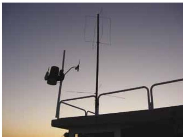
Antena Eggbeater II - ručno izrađena SAT antena za 2m sa cirkularnom polarizacijom na Zvezdarnici Mosor (fotografija: 9A1CIG)
