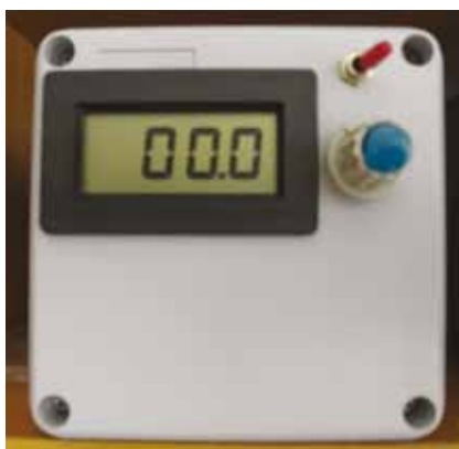
Slika 5. Mjerač impedancije antene, SWR-a, električne dužine kabela i gušenja u kabelu; mjerenje kapaciteta i induktiviteta od 1,8 MHz do 50 MHz (pogled na prednju i zadnju stranu u izradi)
