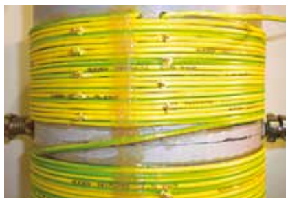
Slika 4. Način učvršćenja navoja ljepilom
