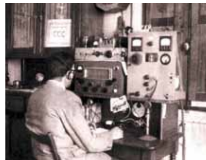
Jorge LU7XP ispred svojih uređaja godine 1956. Predajnik je bio s dvije 807-ice, a prijammik Meissner.
