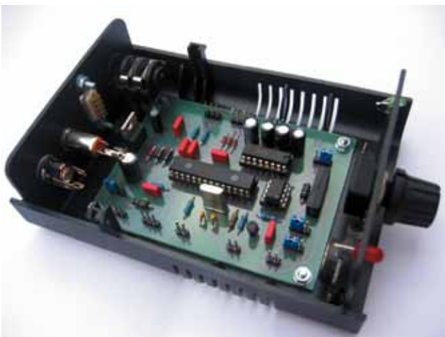
Slika 7. Tiskana pločica ugrađena u kutiju elektroničkog tipkala
