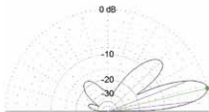
Slika 1. Dijagram zračenja 5-el. Yagi antene na visini 1 lambda
