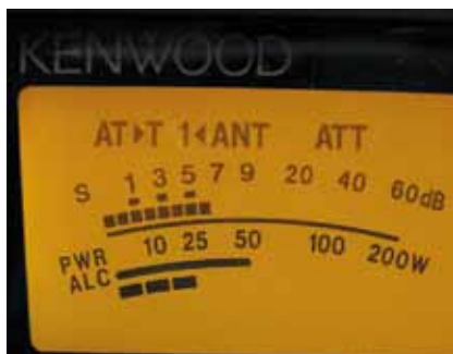
Slika 9. Pokazivanje ALC-a siguran je znak prevelike pobude, izobličenja i velike širine digitalnog signala
