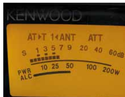
Slika 10. Nema ALC-a uz punu snagu – siguran pokazatelj dobre kvalitete digitalnog signala
