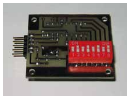
Slika 5. DIP prekidač montiran s donje strane tiskane pločice
