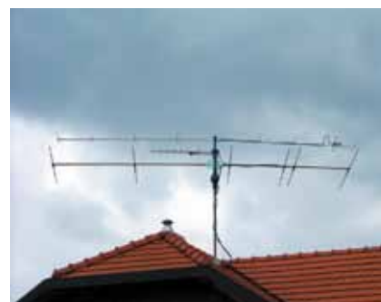
slika 9. 9A5K – 6-elementna antena za 6 m sa „sestricama“ za 2 m i 70 cm
