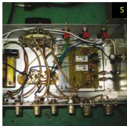
Upravljačka kutija prijemnog sustava s više antena za 160, 80 i 40 m
