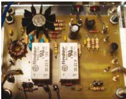
Slika 9. Fotografija pretpojačala W71UV
